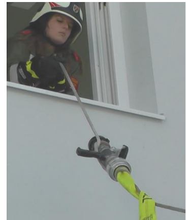
Kreuzklank und Schlag am Strahlrohr, z.B. zum Aufziehen in höhere Stockwerke
