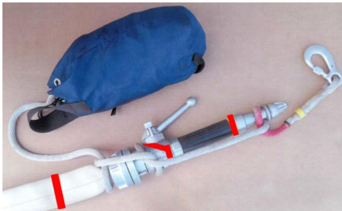
Kreuzklank und Schlag am Strahlrohr, z.B. zum Aufziehen in höhere Stockwerke
